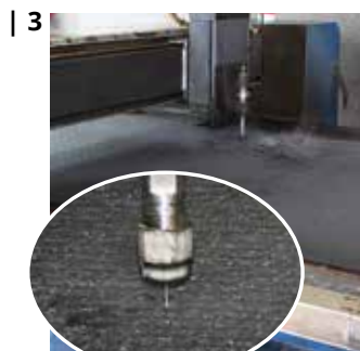
Suivant le dessin CAD, les fentes sont découpées exactement dans les tapis en utilisant la technologie innovante de découpe au jet d'eau
